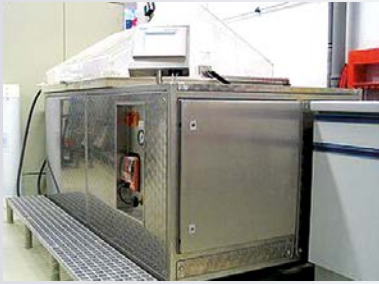
Prüfkammer für die Prüfung nach DIN EN ISO 9227 NSS
