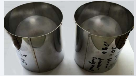
Probe 1 Stromstärke 30 A Schweiß- geschwindigkeit 90 cm/min Probe 2 Stromstärke 30 A Schweiß- geschwindigkeit 190 cm/min
