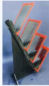
Anordnung der Proben auf dem Ständer
